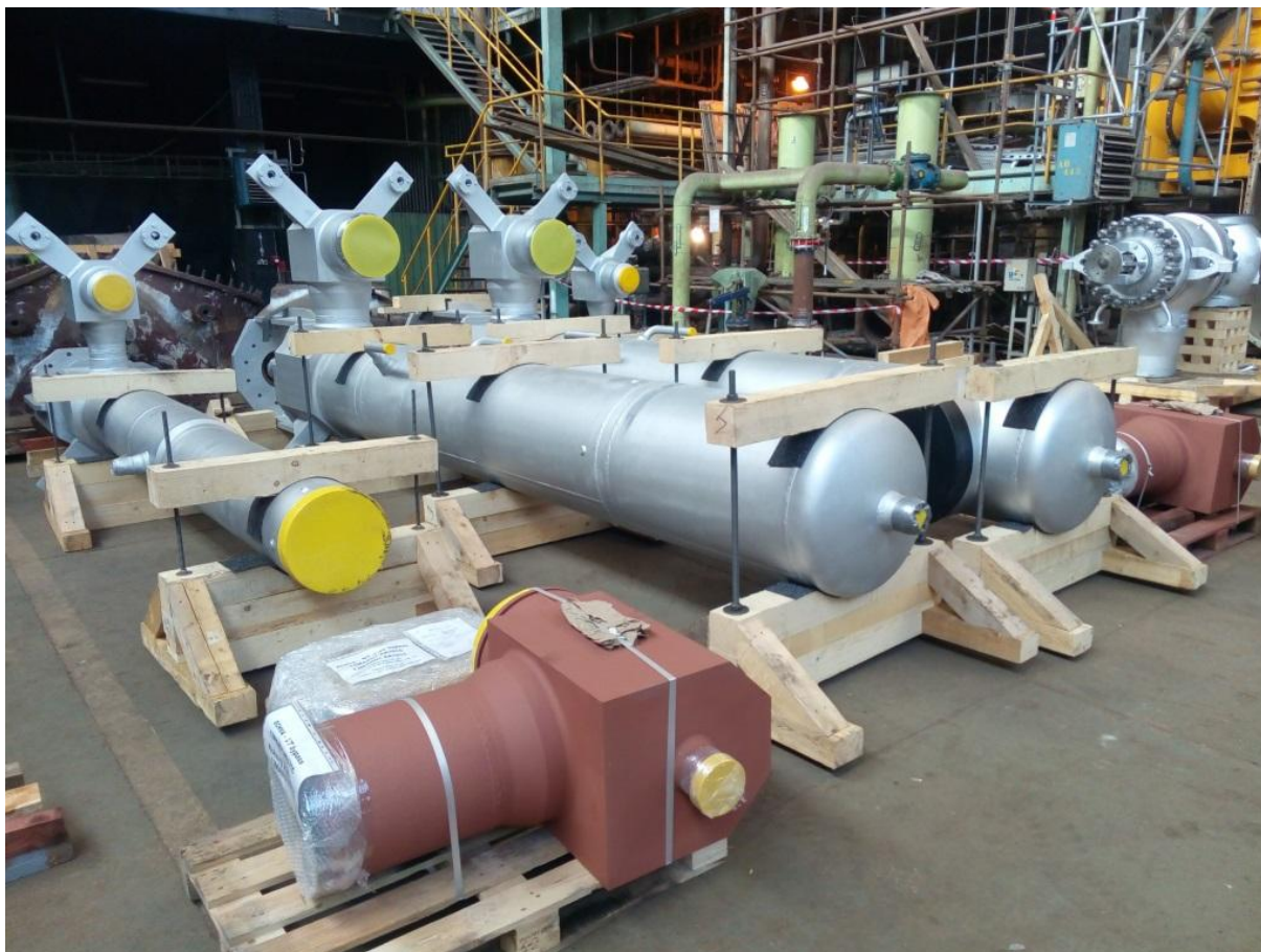
Chvaletice - dodávka nových bypassů na stavbu
