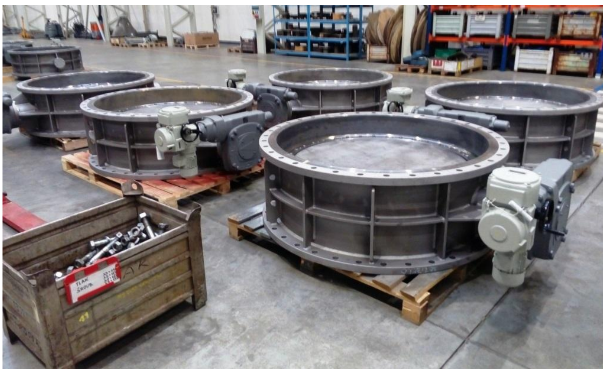
Chvaletice - přejímka nových klapek DN1600 pro chladící vodu
